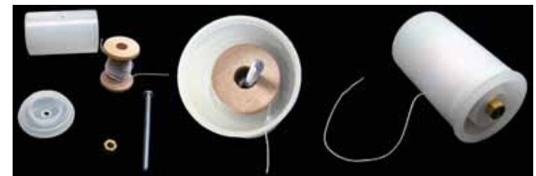
Dispositivo sencillo de rastreo usando un carrete de hilo.
